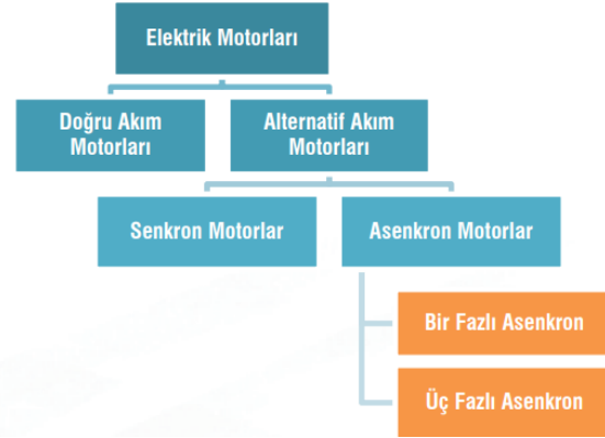
Şekil 1 Motor Tasarımlarına ve Yapılarına göre Elektrik Motorları
